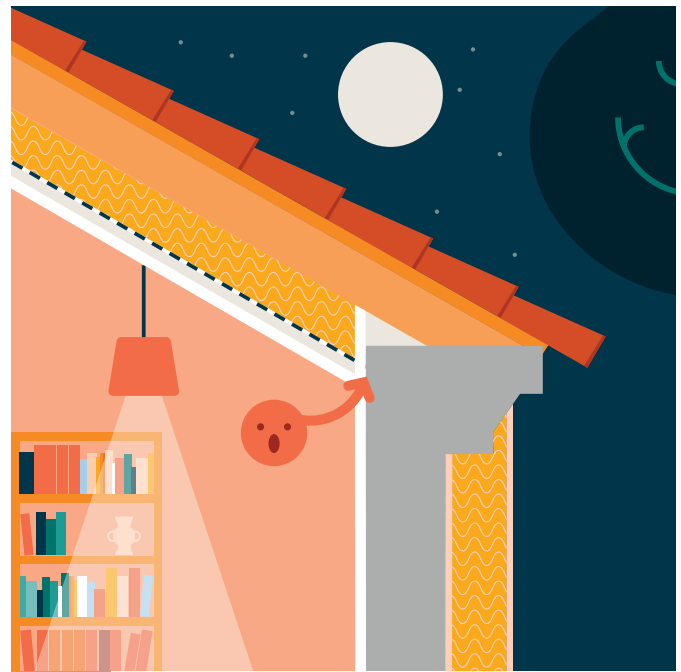
Étape 2 Isolations des rampants
