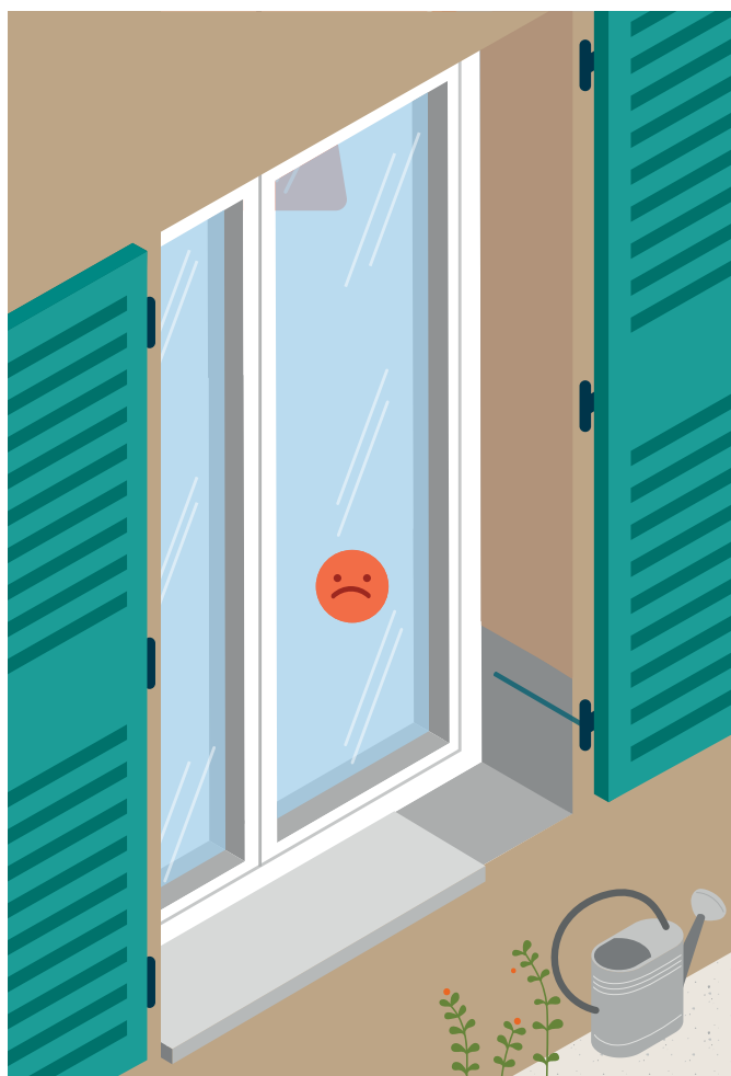
Étape 1 Remplacement des menuiseries extérieures posées en tunnel et des volets battants
