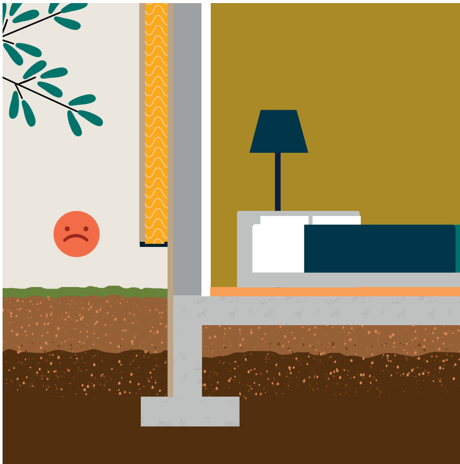
Étape 1 Isolation des murs par l'extérieur
