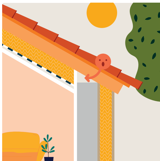
Étape 2 Isolation de la toiture côté intérieur (rampants)
