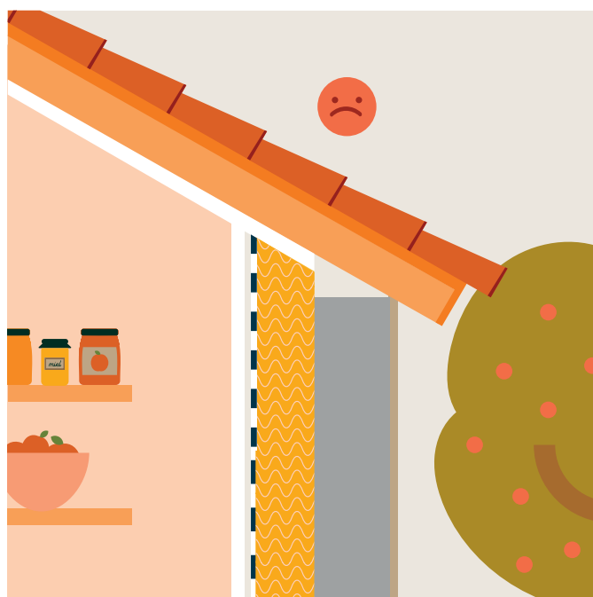
Étape 1 Isolation des murs par l'intérieur
