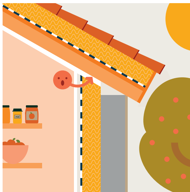
Étape 2 Isolation de la toiture par l'extérieur (sarking)
