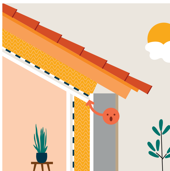
Étape 2 Isolation des murs par l'intérieur
