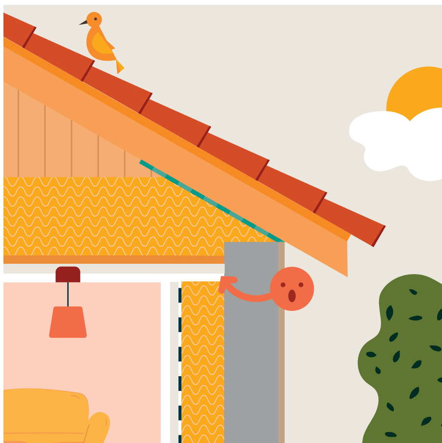
Étape 2 Isolation des murs par l'intérieur jusqu'au faux plafond
