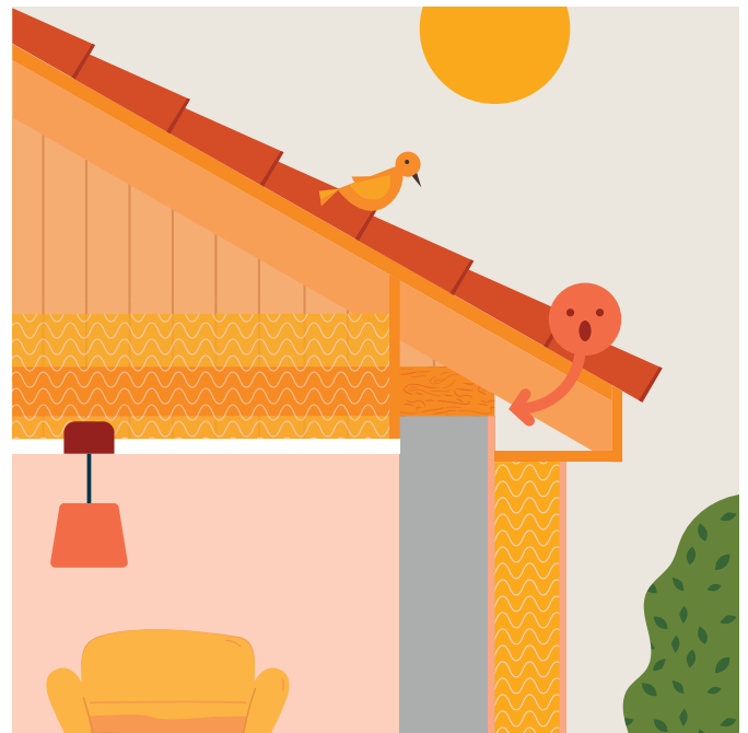
Étape 2 Isolation des combles perdus
