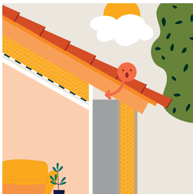
Étape 2 Isolation des murs par l'extérieur
