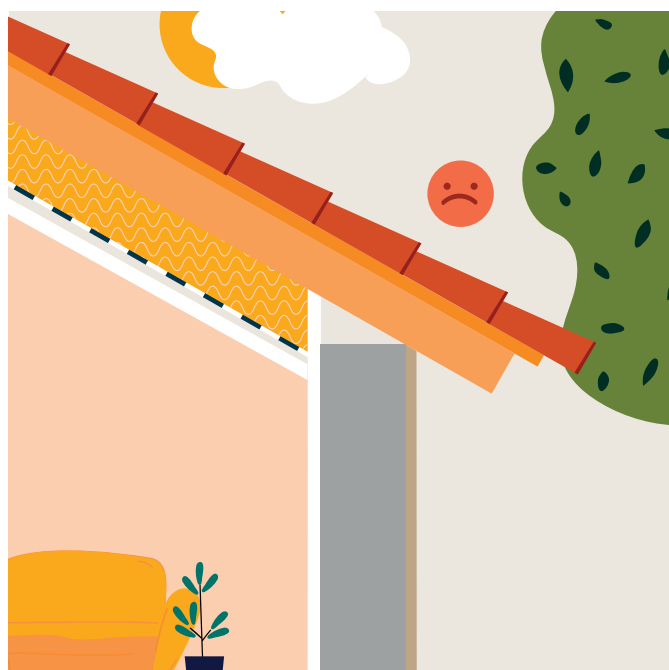
Étape 1 Isolation des rampants
