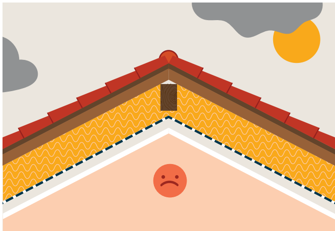
Étape 1 Isolation de la toiture par l'intérieur
